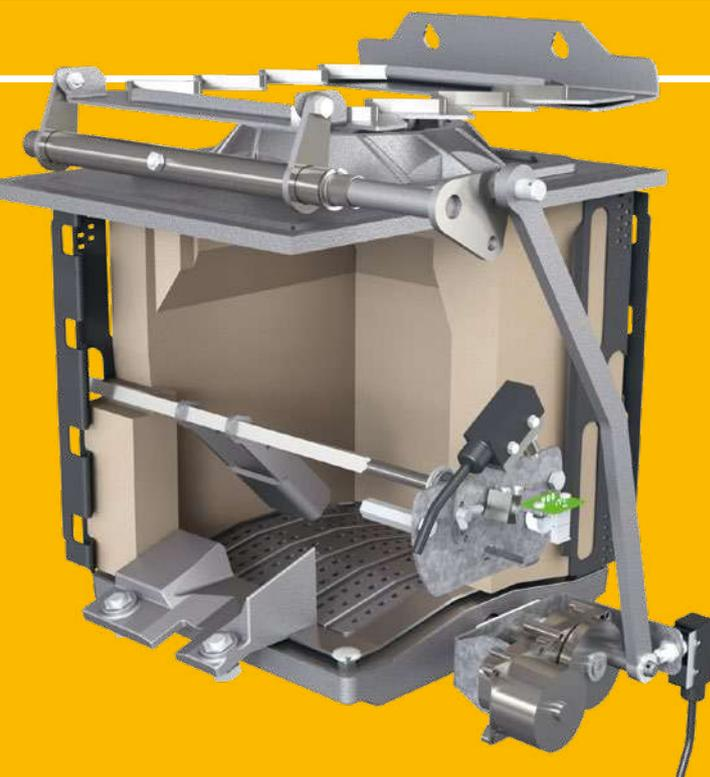
**Optimierte Zündung spart Energie.** Bei kurzen Feuerpausen bleibt die Schamottbrennkammer heiß genug, damit sich frisch eingeschobenes Brennmaterial einfach an der Restglut entzündet. Nur nach längerem Kesselstillstand kommt die geräuschlose Zündung zum Einsatz. Sobald Lambdasonde und Abgastemperaturfühler signalisieren, dass der Zündvorgang erfolgreich war, schaltet sich die Zündung sofort ab. Das spart Energie!
