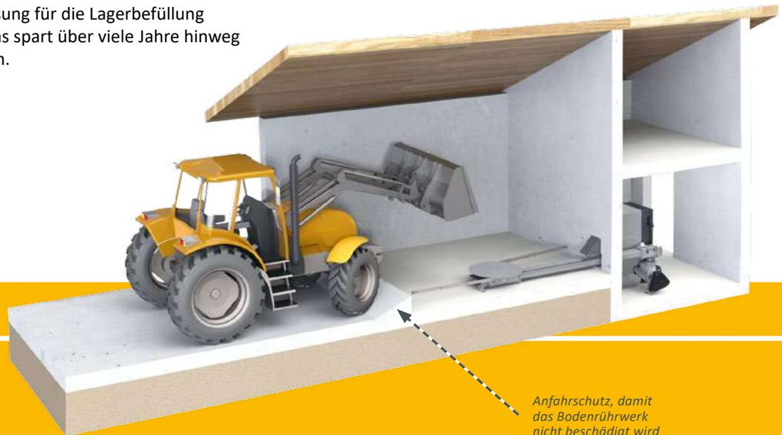
*Anfahrerschutz, damit das Bodenrührwerk nicht beschädigt wird*
